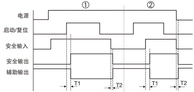
注1: 该图为手动复位连接模式下的动作特性图, 在自动复位模式下启动/复位始终处于高电平
